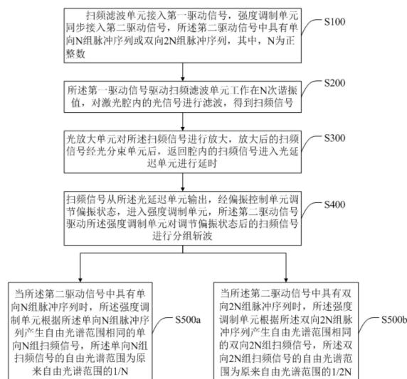
1. 一种分组跳模时域调制方法,应用于傅里叶锁模激光器,其特征在于,所述傅里叶锁模激光器包括:通过光纤连接构成光回路的扫频滤波单元、光放大单元、光分束单元、光延迟单元、偏振控制单元和强度调制单元;
